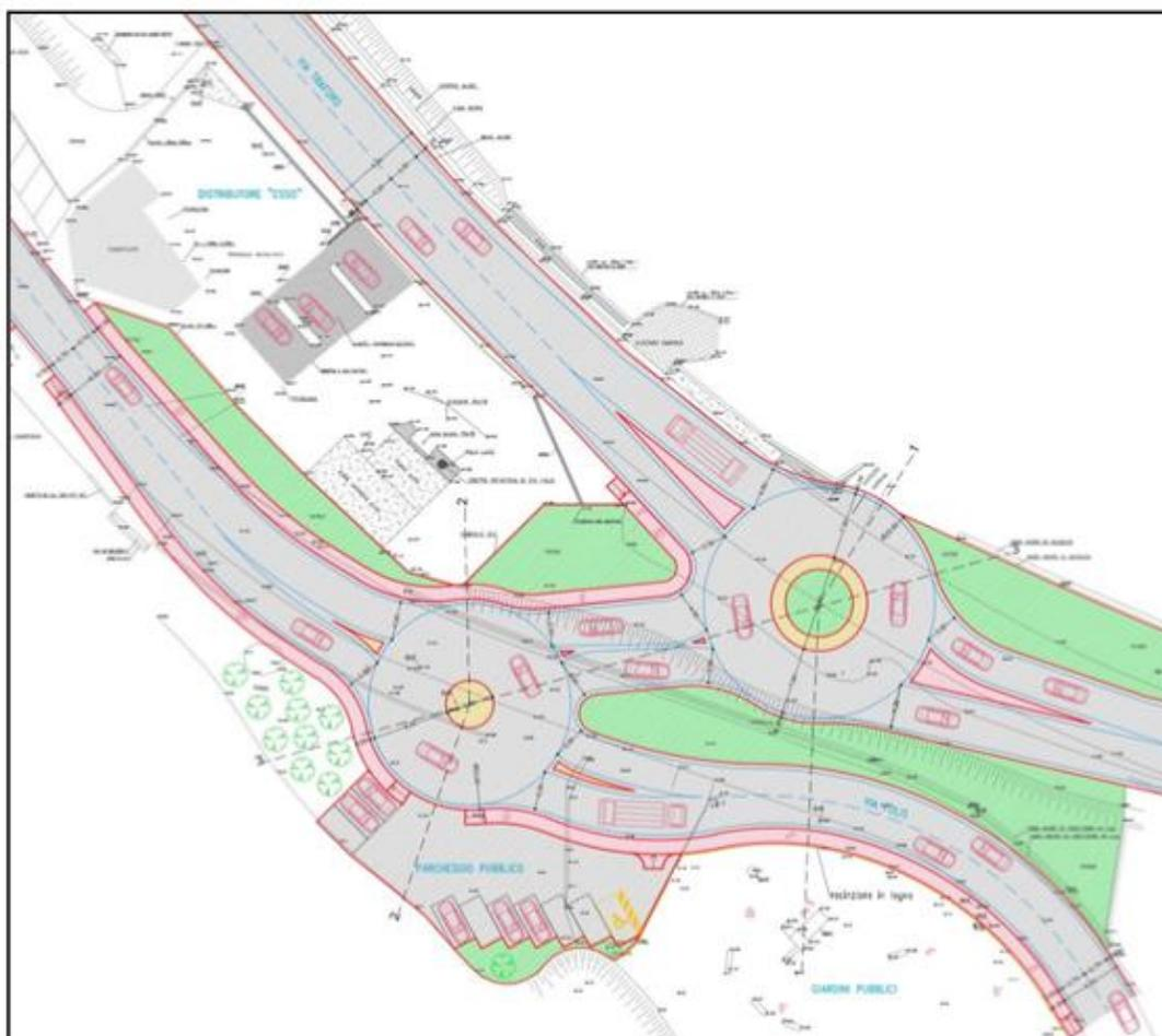
**Figura 34: progetto di rotatoria tra via Traforo (SP10) e via Folis (P.U.T., figura 10)**
