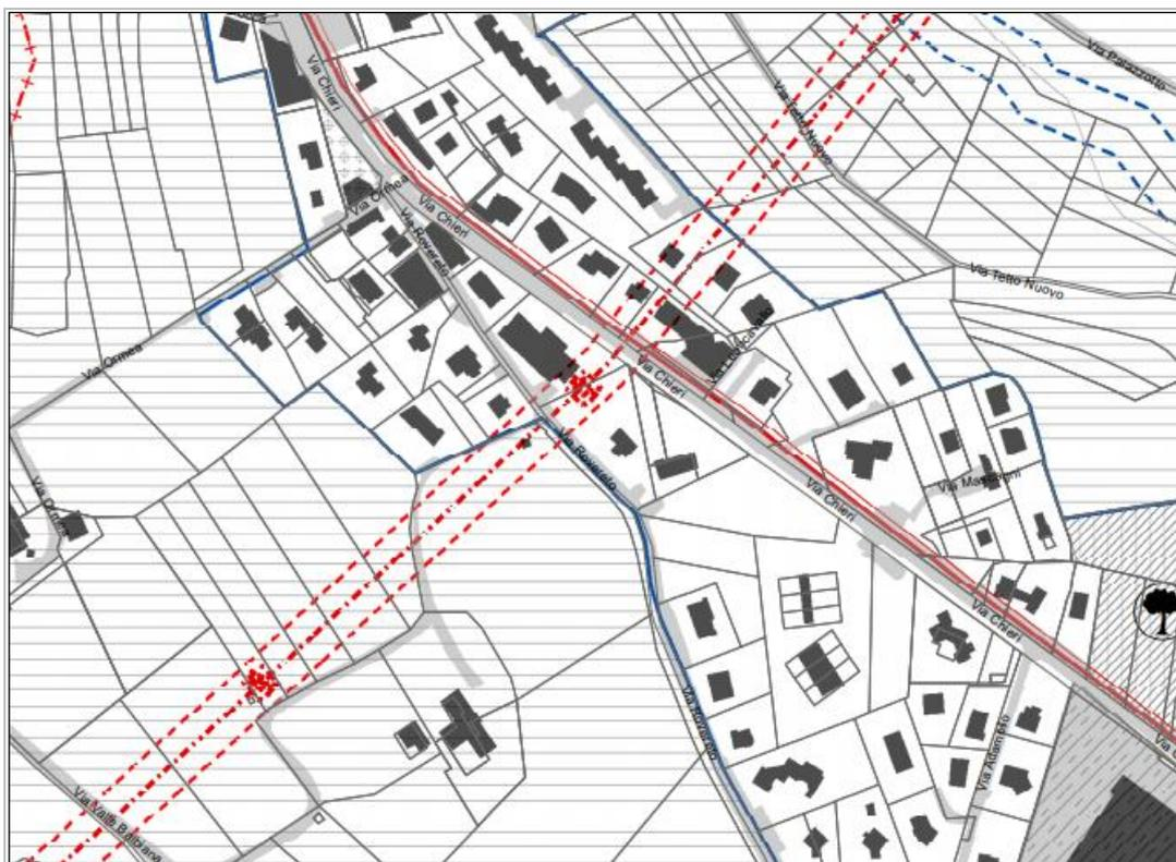
**Figura 49: percorso elettrodotto T389 (attraversamento via Rovereto e via Chieri)**
