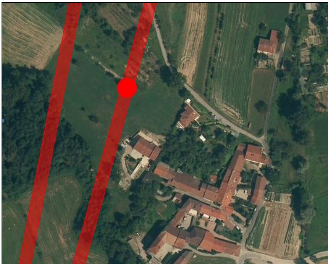
Figura 4.8/4 percorso elettrodotto T 239 e 359 (via Montolino)
